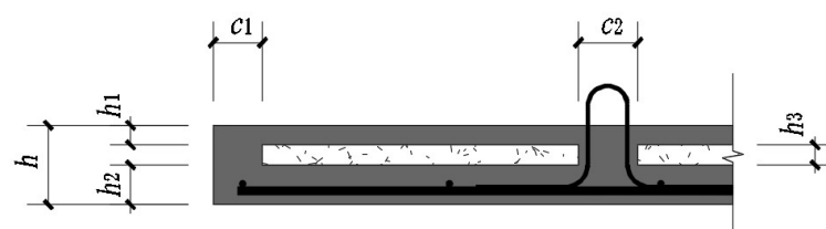
图 5.2.2-2 夹芯预制底板截面构造示意
