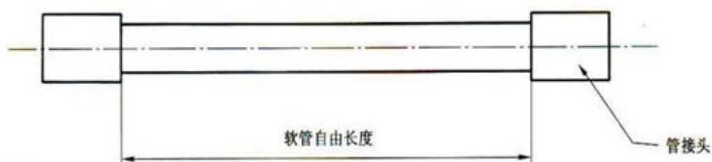
图 1 软管自由长度示意图
