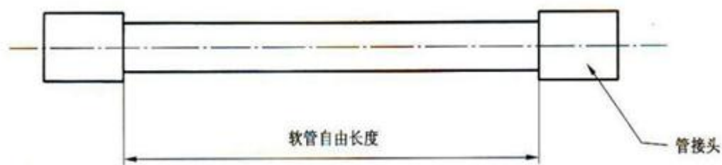
图 1 软管自由长度示意图
